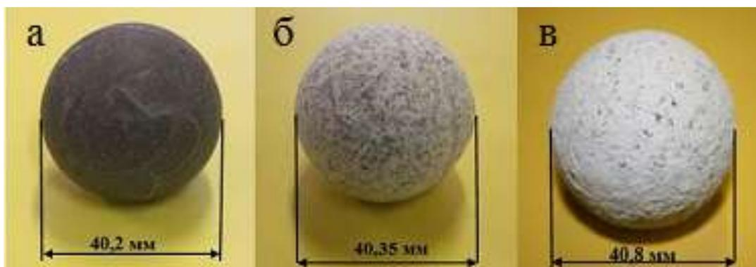
Рисунок 7 – Мелющие шары до (а) и после измельчения в течении 5 (б) и 25 мин (в)
