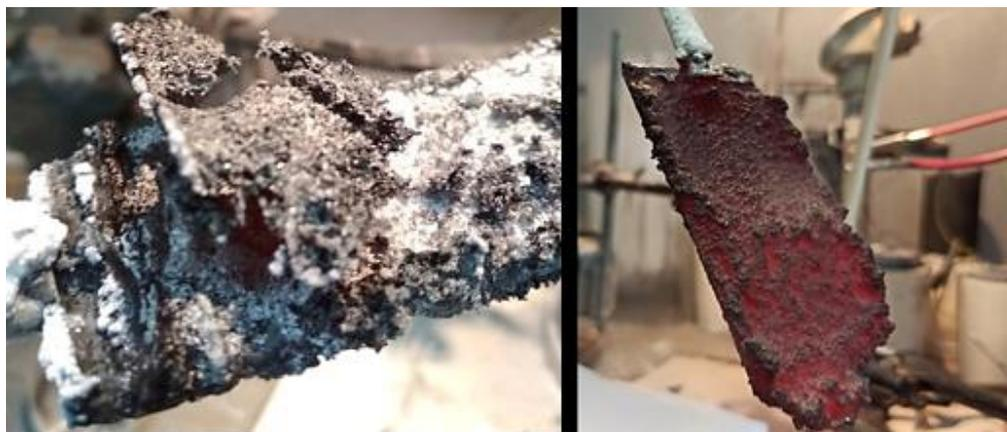
Рисунок 11 – Катодный осадок полученный при электролизе расплава 1,5 KF-AlF<sub>3</sub>-Sc<sub>2</sub>O<sub>3</sub> и 1,5 [KF-(10 мас.%) NaF]-AlF<sub>3</sub>-Sc<sub>2</sub>O<sub>3</sub>
