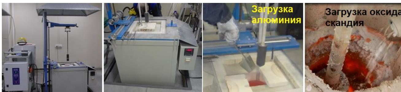
Рисунок 15 – Фотографии укрупненного лабораторного электролизера для непрерывного электролитического получения лигатуры Al-Sc
