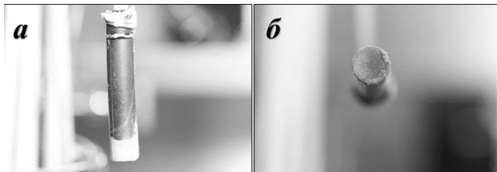
Рисунок 10 – Фотографии анода \text{NiO-Li}_2\text{O} после 35 ч электролиза a – до отмывки электролита; б – после отмывки электролита
