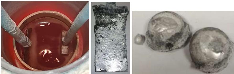
Рисунок 22 – Фотографии электролизера в ходе электролиза расплава  $\text{KF-NaF-AlF}_3\text{-Al}_2\text{O}_3$  при  $800^\circ\text{C}$ , а также катода и алюминия после электролиза
